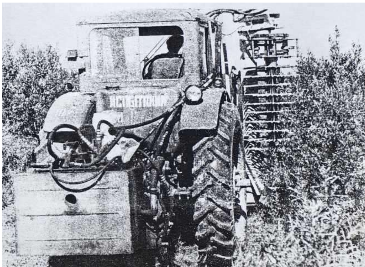
Рис. 5.38. Экспериментальная полевая установка с навешенным на ней бигармоническим вибрационным рабочим органом: а – вид спереди; б – вид сзади
